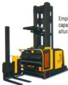
Empilhadeira Elétrica Trilateral, capacidade até 1,5 t., altura de elevação até 13,0 m.
